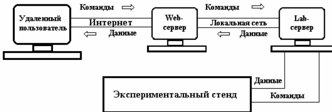
Рис. 7. Потоки команд и данных при разделенных управляющем компьютере и Web-сервере
