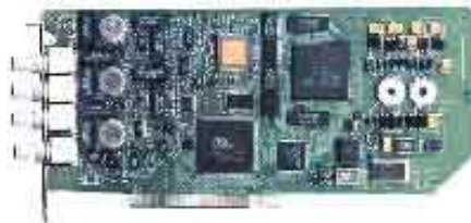
Рис. 4. Быстродействующая плата аналого-цифрового преобразования для шины PCI
